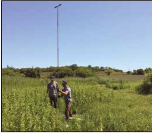
Etablering af en pejlestation med håndbor. I samme ombæring foretages jordartsbeskrivelser for boringen. Foto: WatsonC.
